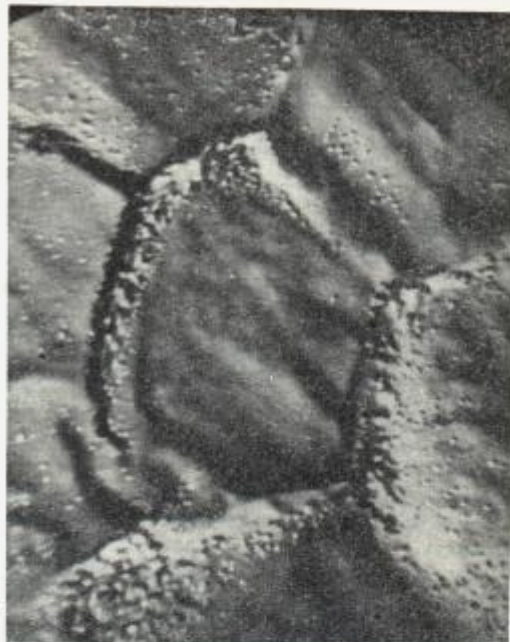
Рис. 6. Поверхность облученного урана (снято электронным микроскопом при увеличении в 15 000 раз).
